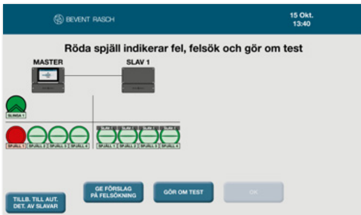
Exempelsystem med 1 st rökdetektor slinga och 8 st brandspjäll med ett felaktigt eller trasigt spjäll.
