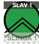
"SLAV 1" Indikerar vilken slavenhet detektorslingan tillhör.
