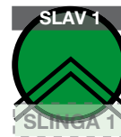
"SLAV 1" Indikerar vilken slavenhet detektorslingan tillhör.
