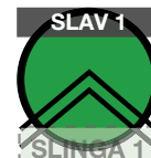
"SLAV 1" Indikerar vilken slavenhet detektorslingan tillhör.
