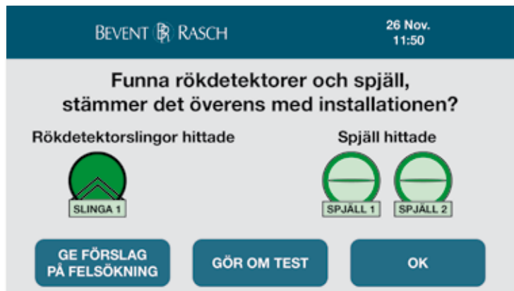
Exempelsystem med 1 st rökdetektorer och 2 st brandspjäll.
