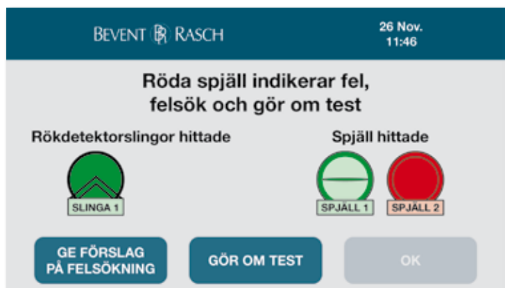
Exempelsystem med 1 st rökdetektorer och 2 st brandspjäll med ett felaktigt eller trasigt spjäll.
