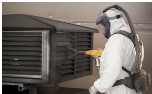
Pulverlackering på färdiga produkter ger gott korrositetsskydd.
